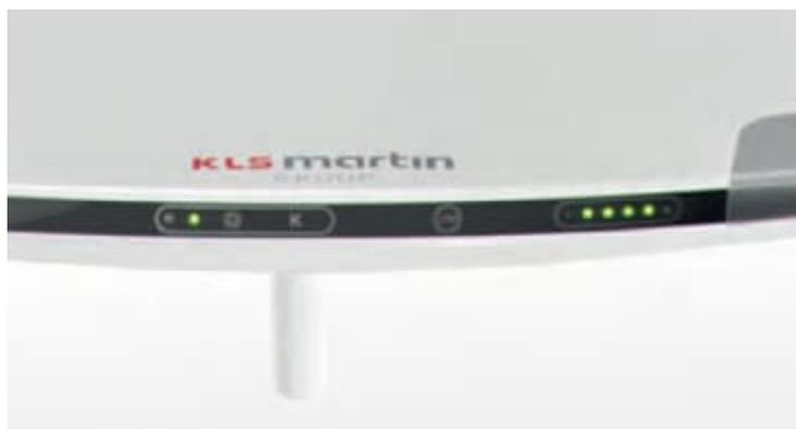
**Панель купола** С панели на корпусе купола вы можете регулировать диаметр управления светового поля (14-25 см), цветовую температуру (3000-5500 K), на корпусе регулировать яркость (1-100%) и форму светового поля. же вы можете управлять параметрами встроенной камеры.
