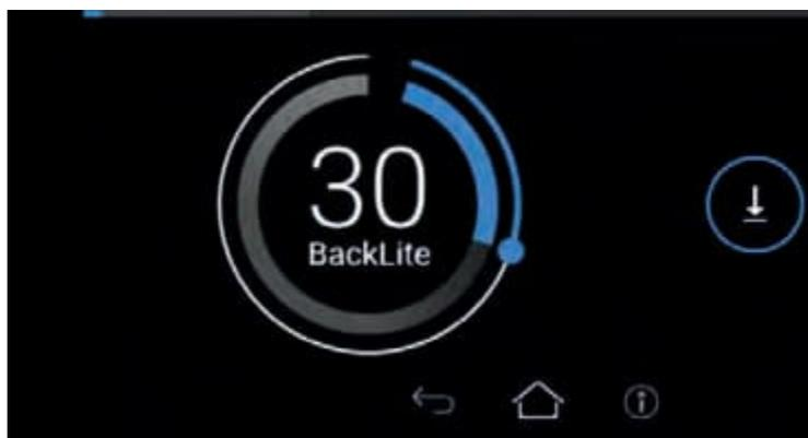
Регулировка Яркость света регулируется от 30% до 100% в обычном режиме.
