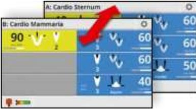
SWAP позволяет с помощью ножного переключателя или рукоятки переключаться между заранее сохраненными режимами работы (аппарат позволяет сохранить до 40 режимов). Благодаря этому хирург может быстро изменить мощность резания или коагуляции, не покидая операционный стол.
